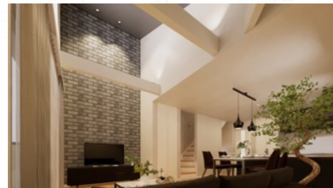
リビング_ダウンライト 勾配天井からタイルの壁を照らすダウンライト。 タイルの壁が強調され、高級感を演出。
