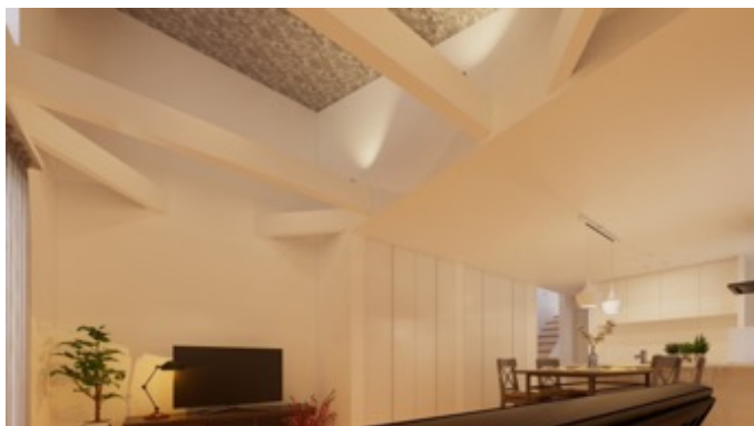
リビング_間接照明(調光器付) 勾配天井のあらわし梁上部に照明を設置した、 間接照明。勾配天井の天井面を照らし、 反射した光が空間全体を包み込む、 高級感ある上質なリビング照明。
